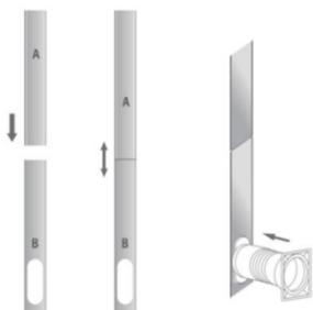
**Étape 4 :** Fermez votre fenêtre pour maintenir le kit en place. Elle doit maintenir le kit de fenêtre bien en place, fixez le kit de fenêtres à l'aide du ruban adhésif si nécessaire. Il est recommandé de sceller l'espace entre l'adaptateur et les côtés de la fenêtre pour obtenir une efficacité maximale.
